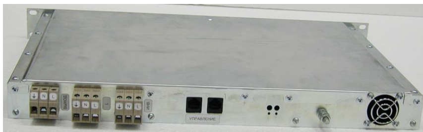
Рисунок 4 – Расположение разъёмов внешних подключений на задней стенке ПЭС
