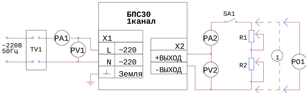
Где: R1, R2 – набор резисторов типа ППБ-15Г или реостатов типа РСП соединенных последовательно или параллельно. Суммарная мощность набора резисторов не менее 40 Вт. Величина суммарного сопротивления приведена в таблице 7.
