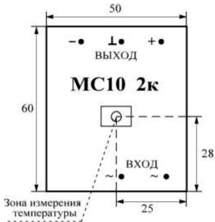
Рисунок Е.2 – Точка измерения температуры корпуса модулей серии MC10_
