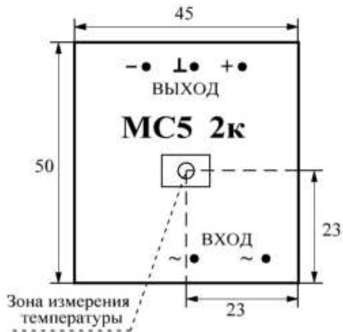
Рисунок Е.1 – Точка измерения температуры корпуса модулей серии МС5_
