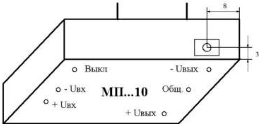
Рисунок Е.1 – Точка измерения температуры корпуса модуля
