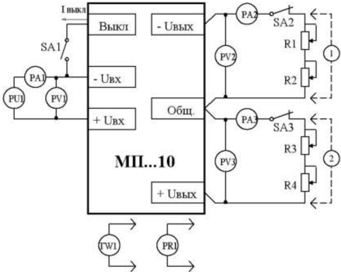
Рисунок Б.1 – Схема проверки электрических параметров модулей
