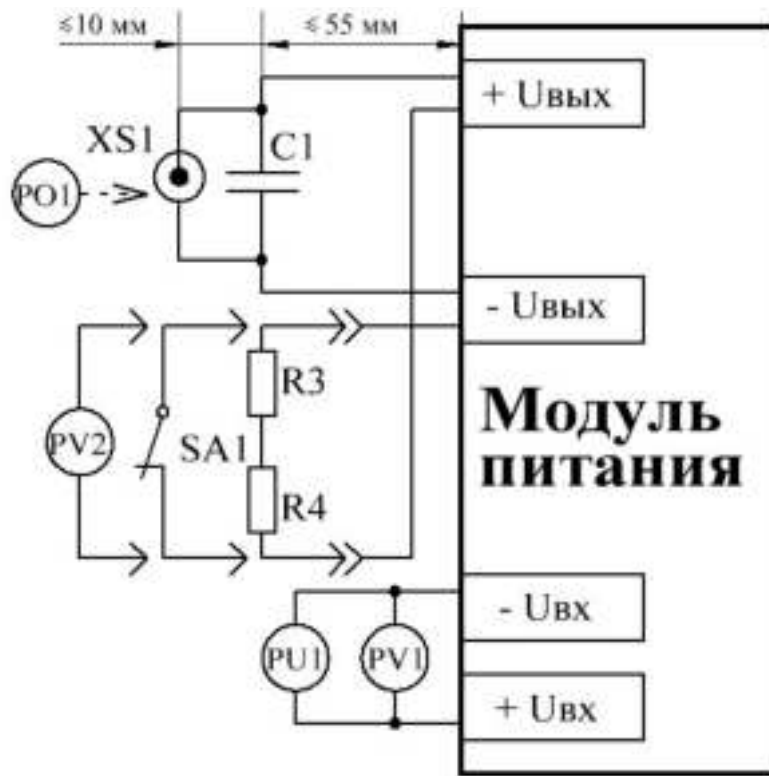
Рисунок Г.1 – Схема проверки амплитуды пульсации выходного напряжения
