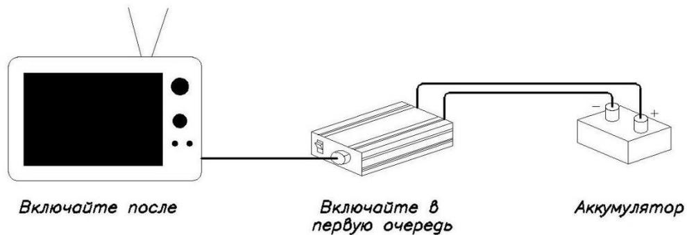
Рисунок 2 – Последовательность включения инвертора и электрооборудования
