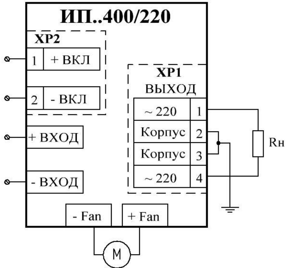
Рисунок Г.1 – Схема включения инвертора
