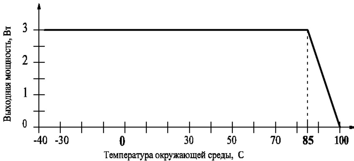
Рисунок Д.2 – Зависимость максимально допустимой выходной мощности от температуры окружающей среды в условиях естественной конвекции
