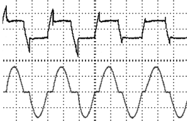
Рис. 6. Осциллограммы синусоидального тока и напряжения плазменной фазы горения дуги при резистивной нагрузке
