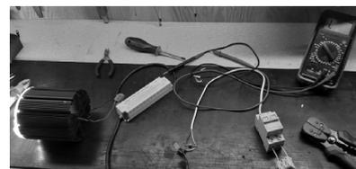
Рис. 8. Испытательная установка с модифицированной схемой устройства защиты № 2
