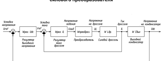
Рис. 3. Структурная схема двухконтурной обратной связи для одной фазы ККМ
