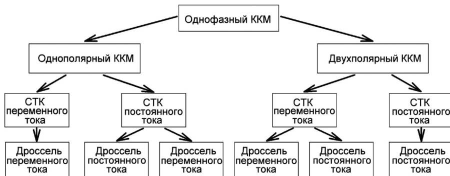
Рис. 2. Классификация силовых каскадов однофазного повышающего ККМ
