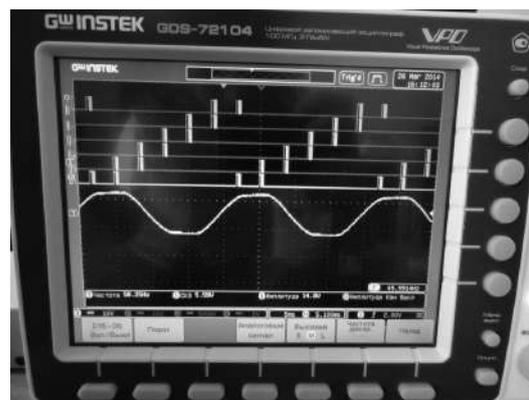
Рис. 8. Осциллограмма фазы А питающей сети и 6 каналов на выходе системы управления с шириной импульса 650 мкс
