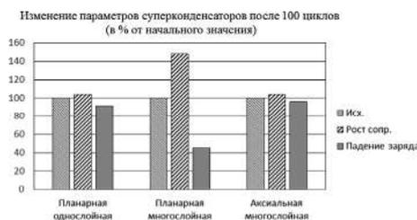
Рис. 2. Изменение параметров суперконденсаторов в процессе зарядки-разрядки после 100 циклов
