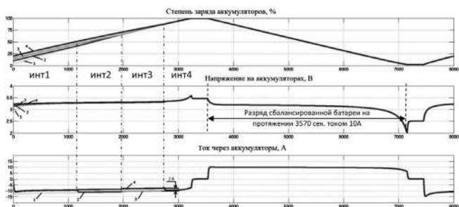
Рис. 9. Графики зарядно-разрядной характеристики несбалансированной LiFePO<sub>4</sub> аккумуляторной батареи с устройством балансировки на повышающих DC/DC преобразователях
