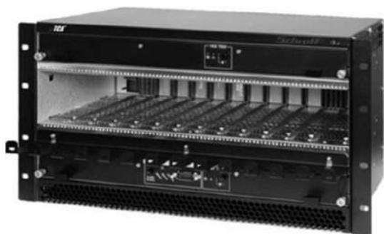
Рис. 8. Крейт устройства на базе стандарта µTCA
