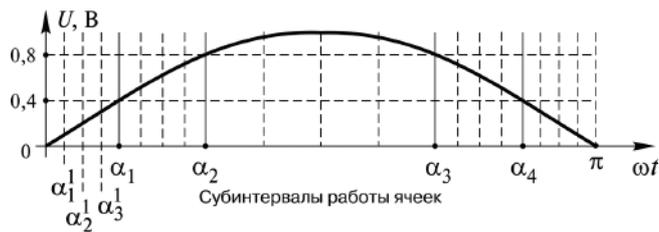
Рис. 3. Разбиение уровней напряжения по времени включения каждой ячейки, исходя из числа ячеек
