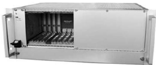
Рис. 4. Крейт устройства на базе стандарта CompactPCI Serial
