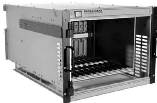
Рис. 10. Крейт устройства на основе стандарта VXI
