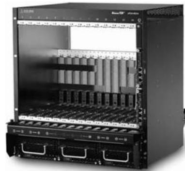
Рис. 6. Крейт устройства на базе стандарта ATCA
