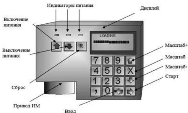
Рис. 5. Внешний вид модуля управления
