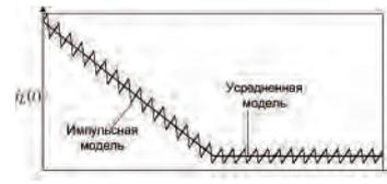
Рис. 3. Временные диаграммы тока индуктивности при переходе из режима непрерывных токов в режим прерывистых токов
