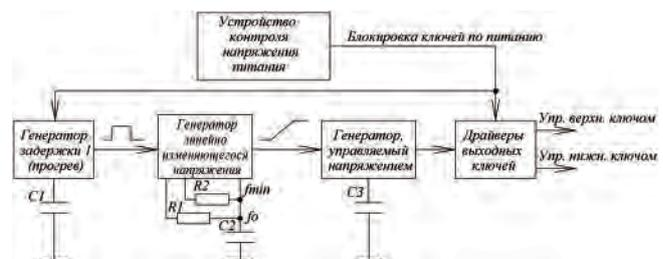
Рис. 1. Функциональная схема типового контроллера балласта люминесцентных ламп
