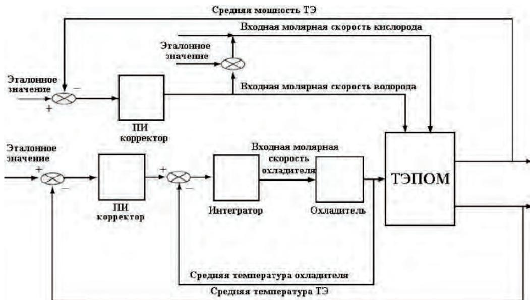
Рис. 9. Управление работой топливного элемента
