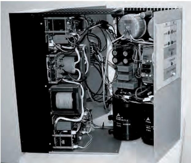
Рис. 13. Конструктивный макет модуля МШБП в раскрытом виде
