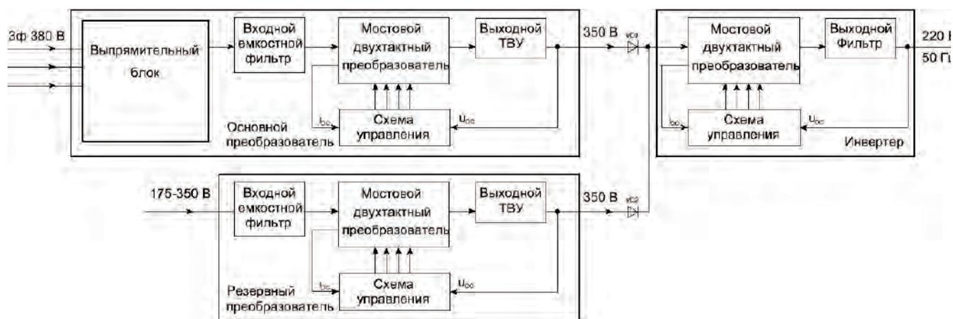
Рис. 4. Блок-схема системы бесперебойного питания
