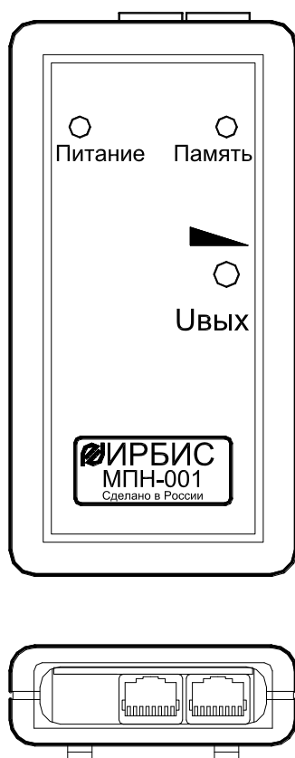
Рис. 7. Модуль подстройки напряжения МРН-001
