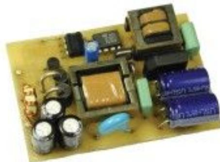
**Модули питания серии ММ10 изготовлены с использованием технологии комбинированного монтажа на импортной элементной базе.**
