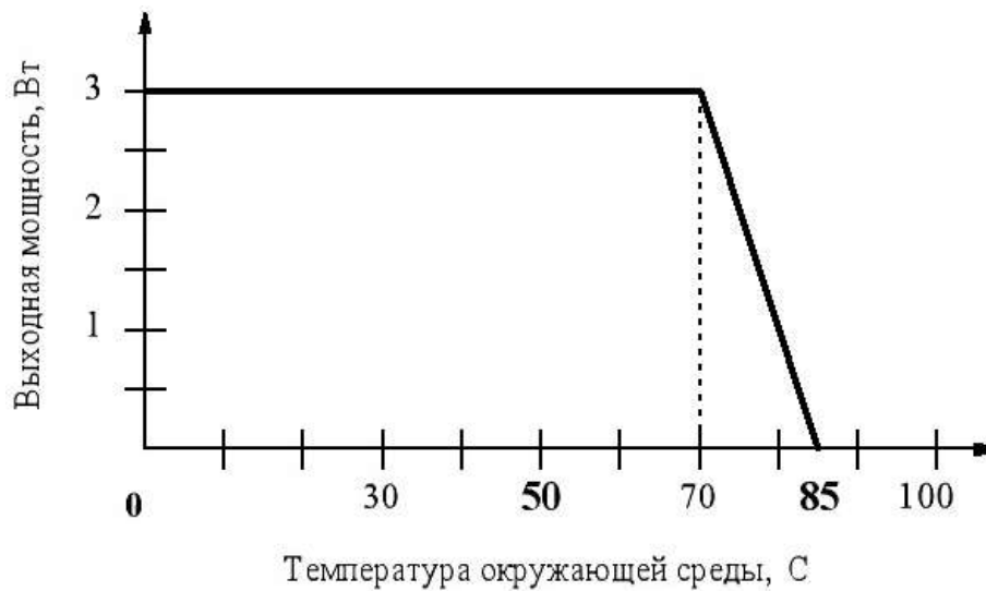
Рисунок Е.2 – Зависимость максимально допустимой выходной мощности от температуры окружающей среды в условиях естественной конвекции.
