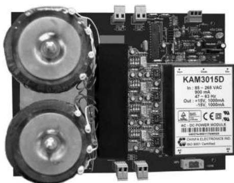
Рис. 1. Модуль – синтезатор переменного тока трехфазный комбинированный
