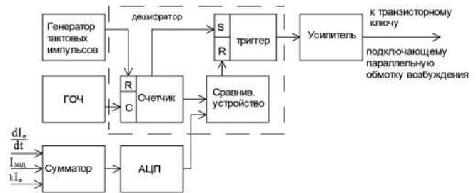
Рис. 1. Функциональная схема пускорегулирующего устройства
