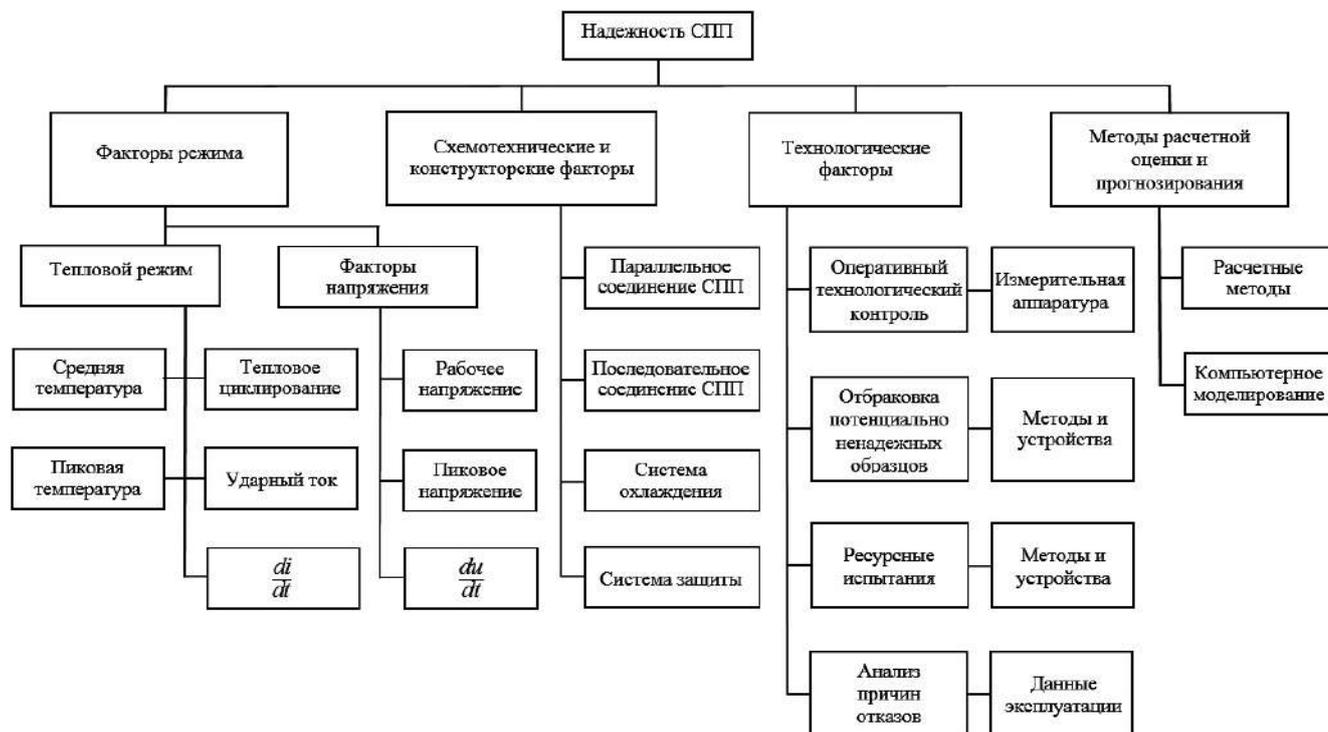
Рис. 1. Система факторов, определяющих надежность силовых полупроводниковых приборов (СПП)
