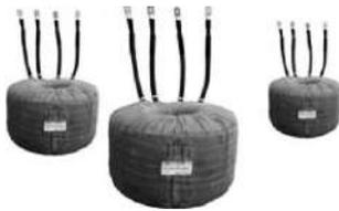
Рис. 5. Тороидальные дроссели переменного тока ЗАО “Тулский завод трансформаторов” дроссели переменного тока [4], с индуктивностью обмотки 2 мГн до 1,25 Гн, рабочим током от 1 А до 125 А, габаритной типовой мощностью до 10 кВАр, массой от 0,8 кг до 39 кг
