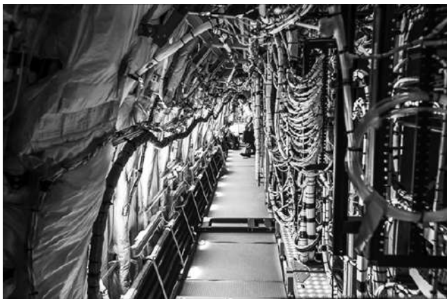
Рис. 1. Бортовая кабельная сеть современного ЛА
