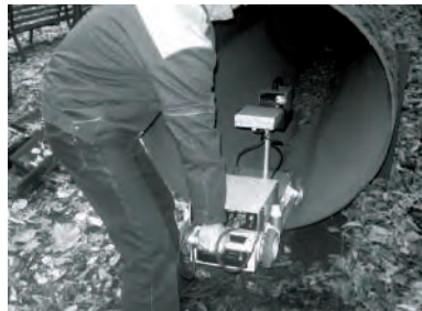
Рис. 8. Рентгеновский аппарат "Сирена-6" для диагностики сварных швов трубопроводов
