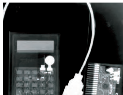
Рис. 6. Рентгенограмма элементов аппаратуры внутри небольшого чемодана (снимок получен с помощью аппарата «СПАРК»)
