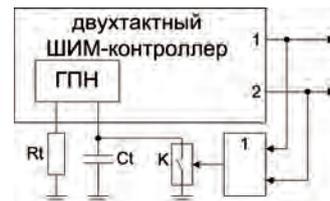
Рис. 2. Функциональная схема формирования неизменной длительности паузы (1, 2 – управляющие выходы ШИМ-контроллера)
