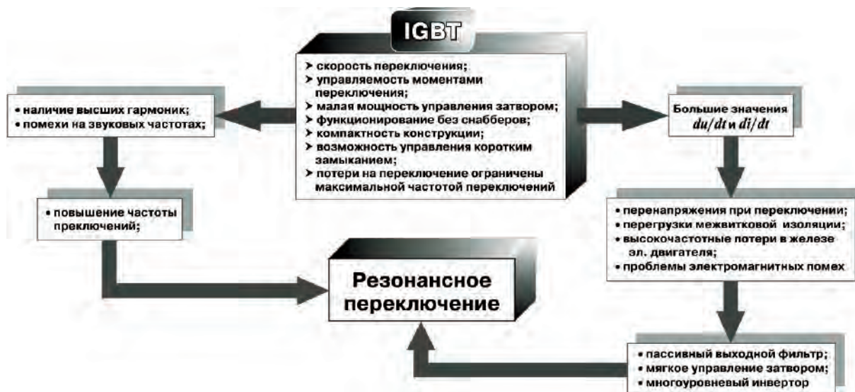
Рис. 1. Обоснование использования мягкого переключения мостового коммутатора на IGBT
