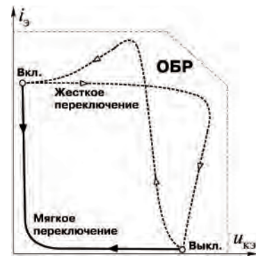
Рис. 3. Траектории ОБР при мягком и жестком переключении
