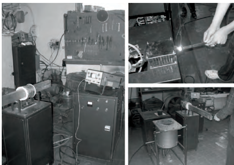
Рис.10 Преобразователь универсальный мощностью до 15 кВт для плавки цветных металлов, обжига прямоугольных стальных труб и пайки резцов по схеме 3
