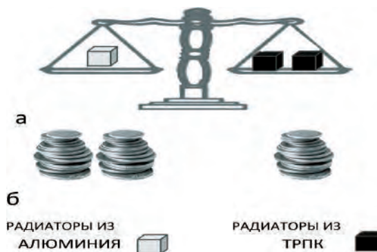
Рис. 3. Сравнение весовых характеристик (а) и себестоимости (б) радиаторов, изготовленных из алюминиевых сплавов и ТРПК
