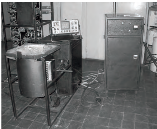
Рис. 8. Установка для плавки цветных металлов емкостью 50 кг по схеме 1
