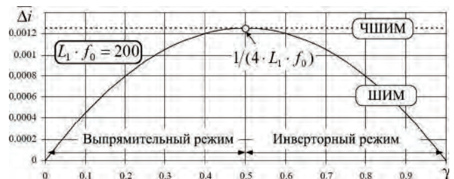
Рис. 6. Зависимость \bar{\Delta i} = f(\gamma, L_1 f_0 = 200) для ОПН с различными законами модуляции
