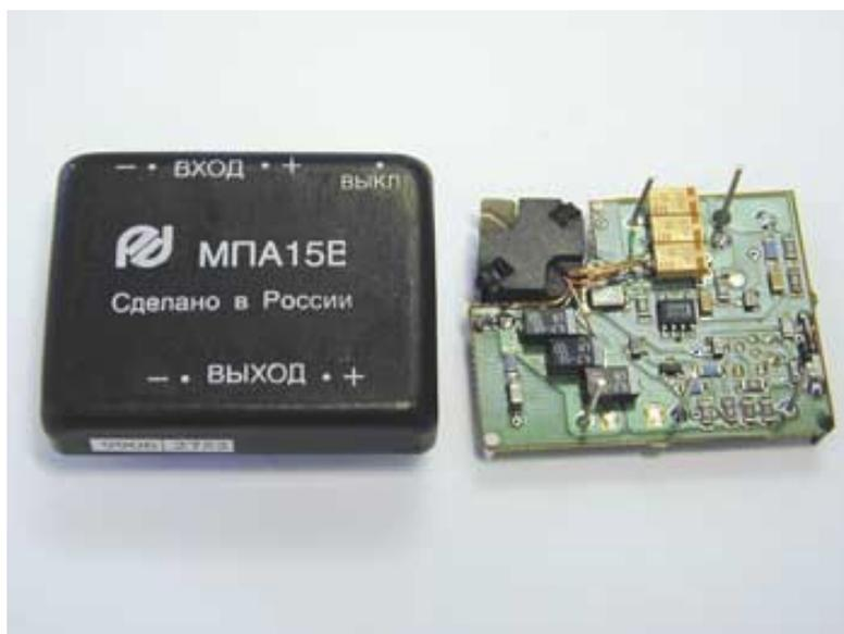
Модули серий МПА15, МПВ15 и МПЕ15 изготовлены по технологии поверхностного монтажа с применением зарубежной элементной базы. Модули не требуют дополнительного теплоотвода.
