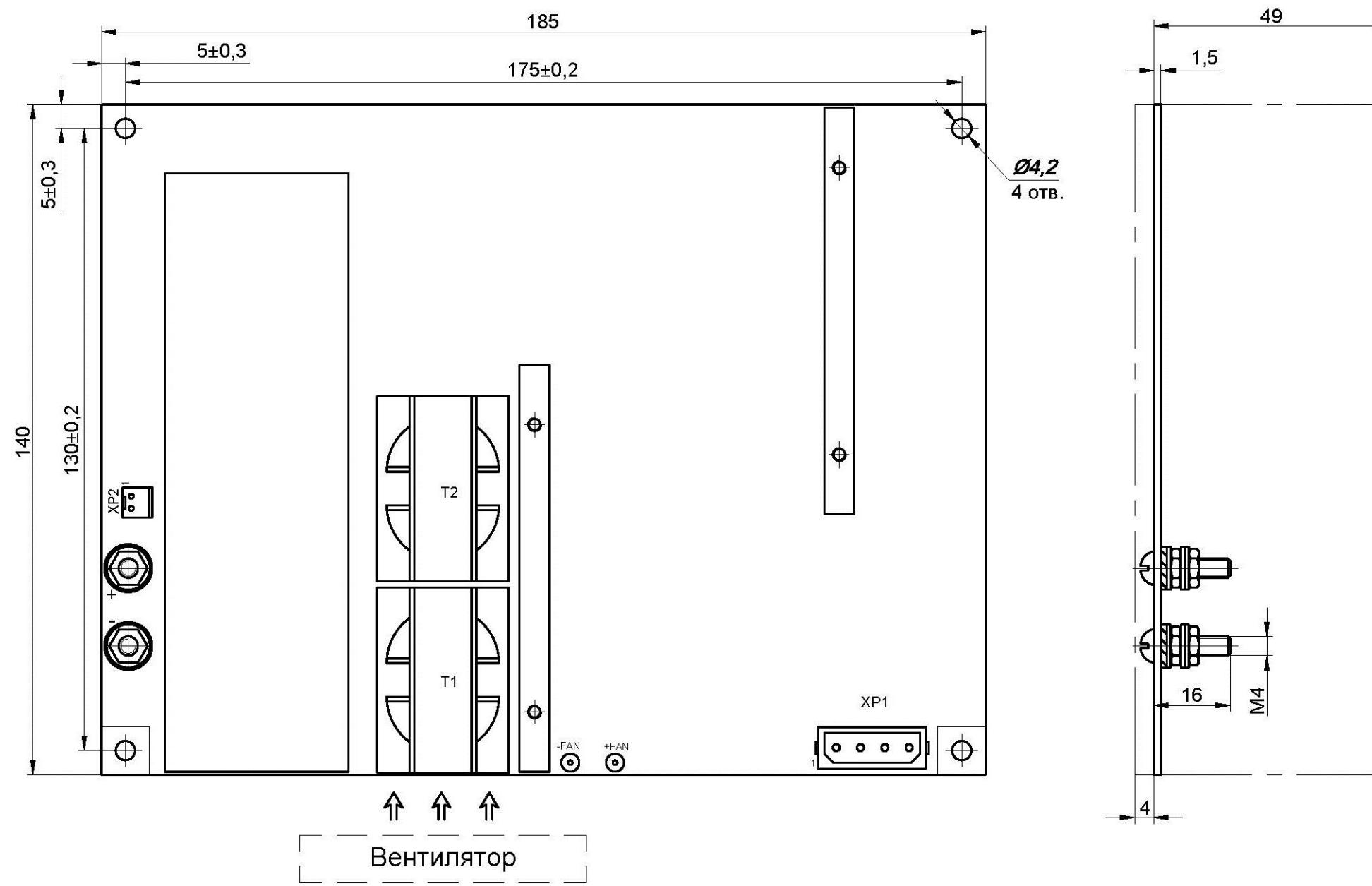
Рисунок Б.1 – Габаритный чертеж инвертора
