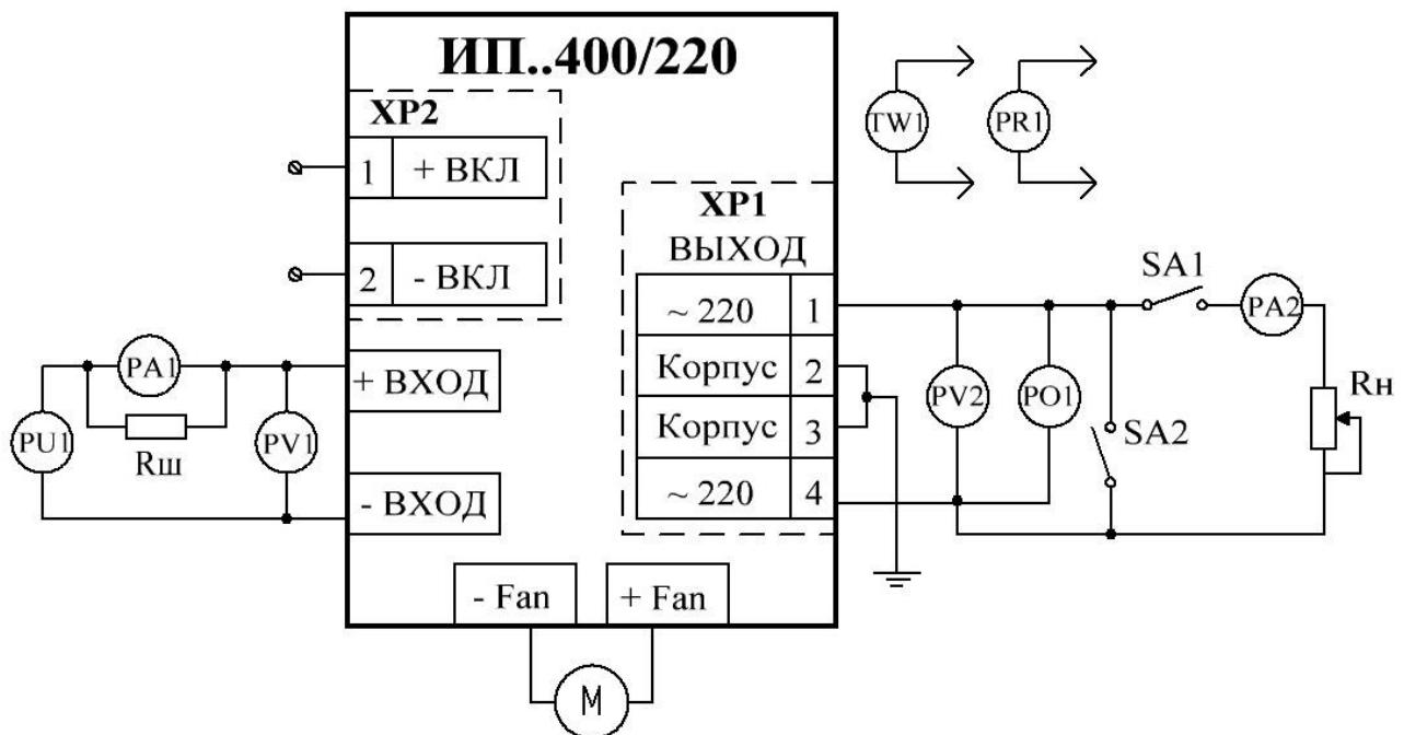
Рисунок В.1 – Схема проверки электрических параметров инверторов
