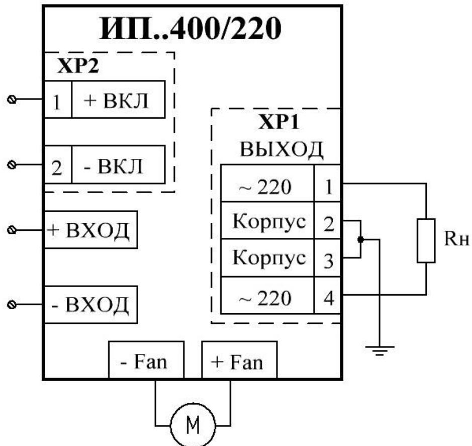
Рисунок Г.1 – Схема включения инвертора
